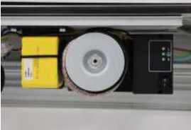
Transformador, baterías 24V Ni-Cd, interruptor de encendido y apagado
