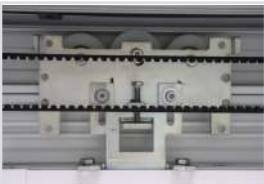
Tres ruedas intercambiables De polioximetileno POM 52 mm
