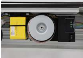
Transformador, baterías 24V NiCd, interruptor de encendido y apagado
